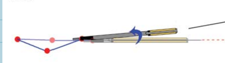
Εικόνα 3. Κατακόρυφη και οριζόντια εκτροπή της βέργας λόγω της οπισθοκρήσης του ψαροτούφεκου.
