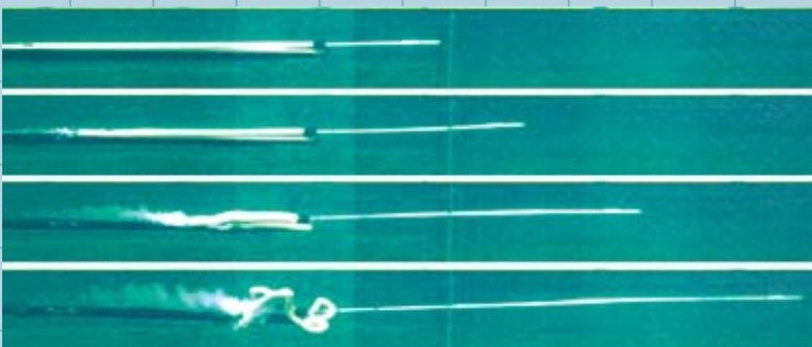
Εικόνα 4. Στιγμιότυπα βολής ψαροτούφεκου με σωλήνα 100cm αλουμινίου, διπλά λάστιχα Ø17.5mm και βέργα Ø6.25mm με πάνω φτερό.
