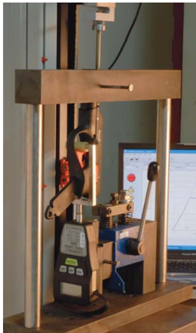
Δοκιμή DS-01-02 : μέτρηση ορίου αντοχής σκανδάλης Test DS-01-02 : determination of endurance limit of trigger mechanism
